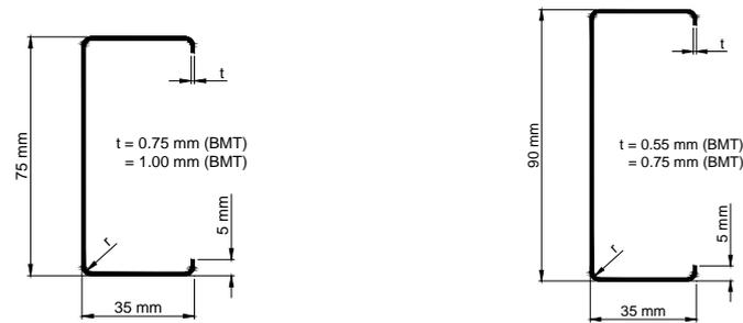
Figure 1. Wall Stud Sections
