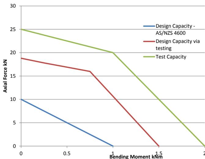
Fig 1. Stud Capacity Curve
